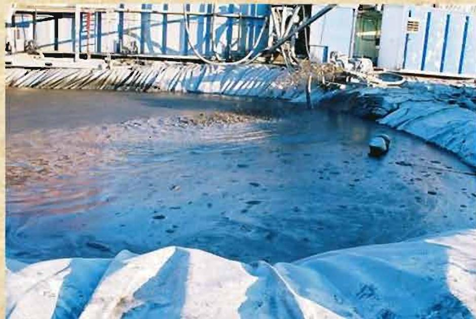
Vasca di decantazione della miscela del fracking "a riposo"
